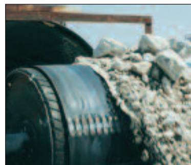
№ 3, самые крупные, предназначены для лент толщиной до 24 мм.
